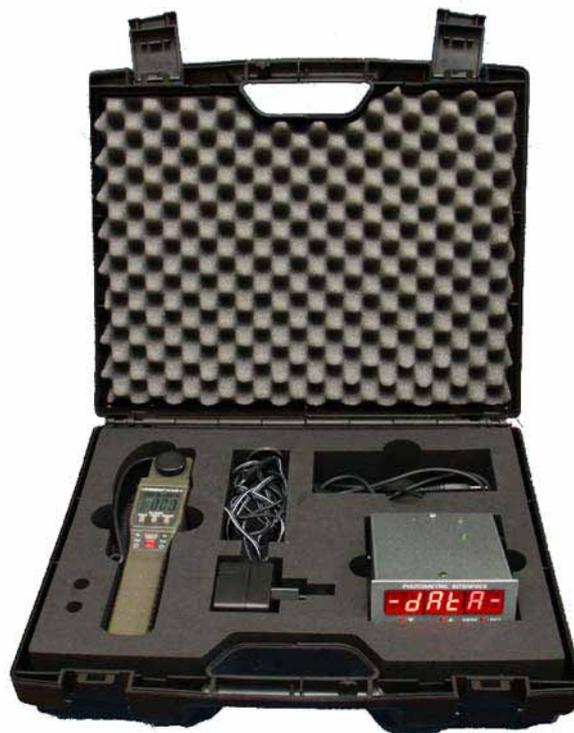
**La valise VPH contient l'équipement nécessaire à l'enregistrement de la luminance max des feux de piste et au temps de rétablissement de la luminance mini en cas de coupure.**
